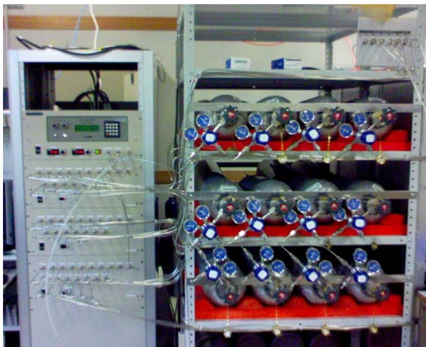
図 2-1 標準ガスの例 (CO<sub>2</sub>) と分析計。
