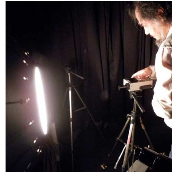
JAXAの積分球を用いた現場輝度計の校正の様子(MS-720:千葉大梶原先生)
