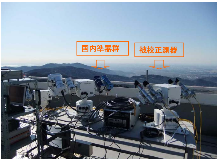
国内準器と被校正測器(直達日射計)との比較観測 (於筑波山)
