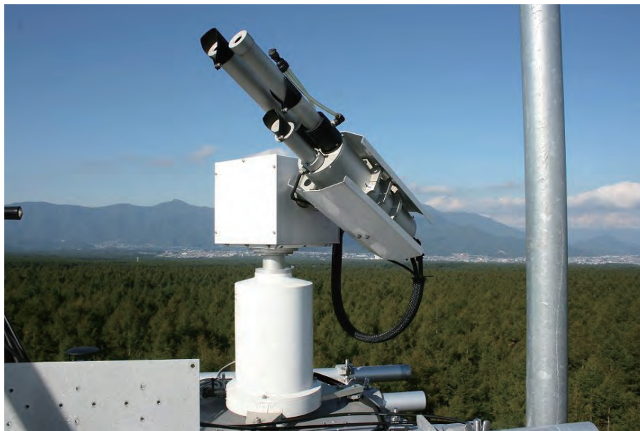
図7-3 タワー上に設置されたスカイラジオメーター（協力 産業技術総合研究所）（富士北麓サイト）。
