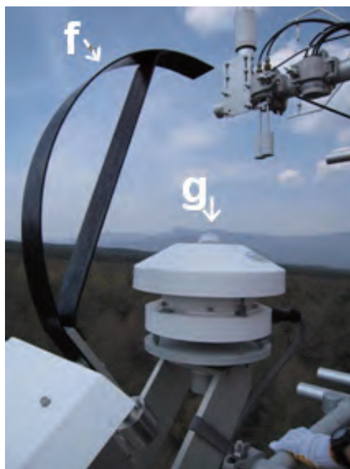
図 7-2 直達・散乱成分を分離するシャドウバンドを設置した分光放射計 (f: シャドウバンド、g: 分光放射計) (富士北麓サイト)。
