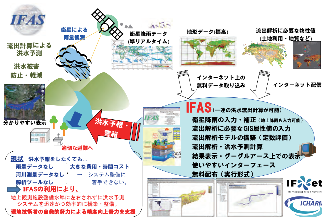
図 3-5 人工衛星観測雨量情報と総合洪水解析システム (IFAS) を基盤とした発展途上国における洪水予警報体制整備促進の概念図。
